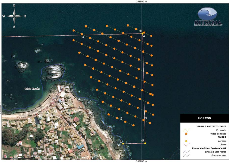
Figura 4. Ejemplo de una grilla previa de muestreo de profundidades y tipos de fondo de un sector del área de manejo de Caleta Horcón, Región de Valparaíso, Chile. Imagen gentileza de Bitecma Ltda.
